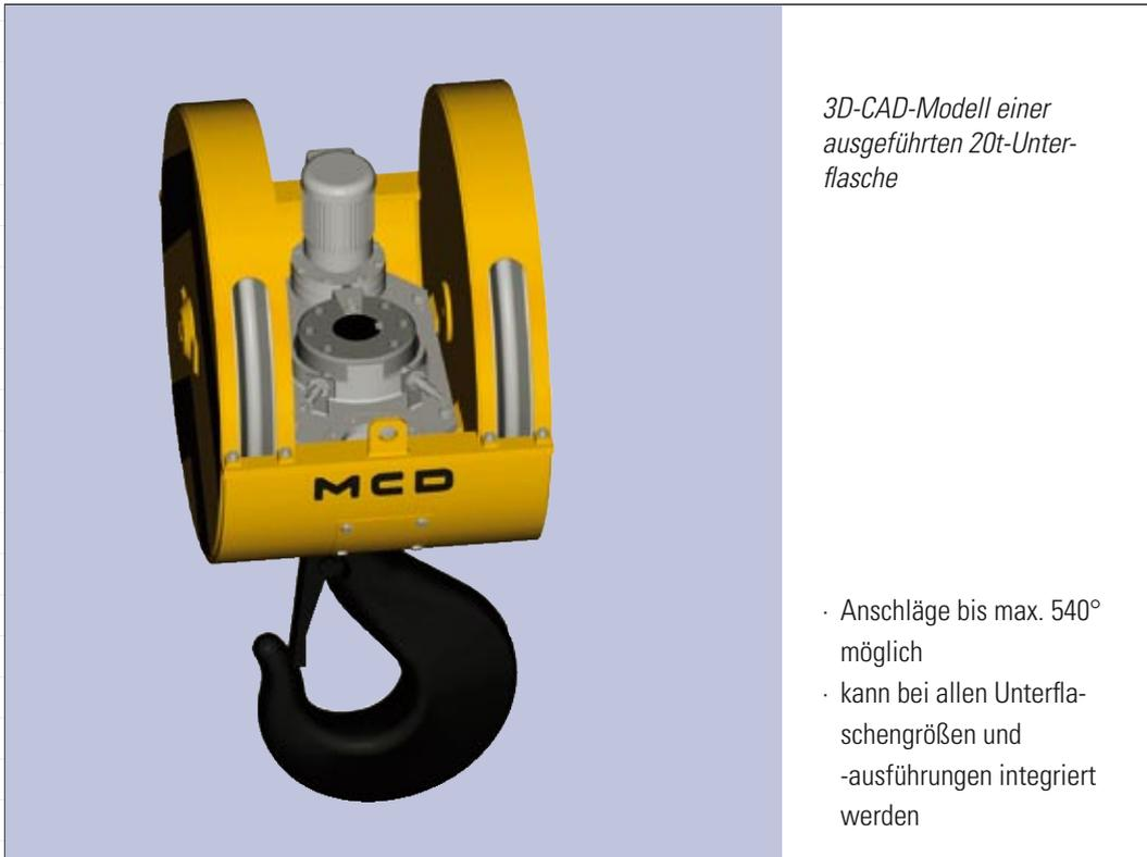
Eine Drehbereichsbegrenzung ist sinnvoll, wenn bestimmte Positionen des Hakens beim Aufnehmen oder Absetzen der Last erreicht werden müssen. Sie ist zwingend erforderlich, wenn ein Lastaufnahmemittel mit elektrischer Zuleitung eingehängt ist: In diesen Fällen verhindert sie, dass die Zuleitung durch wiederholtes Drehen in einer Richtung abgerissen wird.
