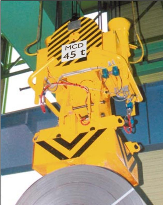
*Unterflasche am Automatikkrane mit Drehwerk, verriegelbarer kardanischer Lastaufhängung und eichfähiger Wiegeeinrichtung*
